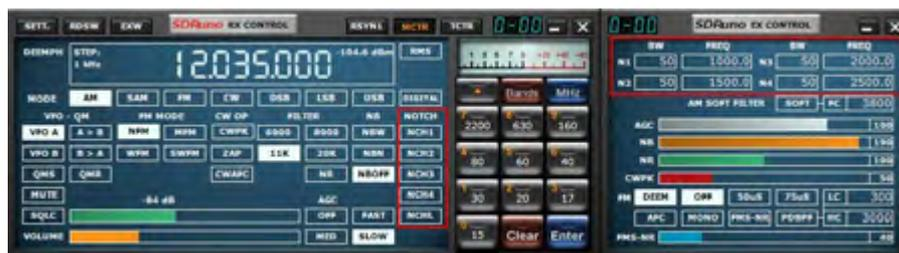
Chaque VRX propose quatre filtres coupe-bande pour supprimer les signaux indésirables placés avant le CAG. Chaque filtre coupe-bande peut être activé/désactivé à l'aide du bouton correspondant dans le panneau de RX Control. Les paramètres BW & Frequency des filtres coupe-bande sont disponibles dans le panneau de commande du RX EX. Pour les filtres coupe-bande 1 et 2, les fréquences peuvent être rapidement réglées «à la volée» comme suit :
