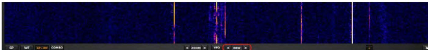
RBW est le détail de l'affichage du spectre. Il détermine combien de résolution est affichée. Une résolution de fréquence très fine peut être obtenue avec des valeurs plus petites. Il n'y a pas de valeur optimale. Cela dépend de la modulation et du niveau de détail que vous souhaitez observer. Abaisser le RBW aura tendance à augmenter la charge du processeur.
