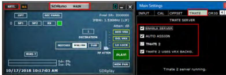
Les options du serveur Tmate ne sont accessibles qu'à partir de l'instance SDRuno N° 0 à partir d'ici : Main panel -> SETT .-> Tmate.
