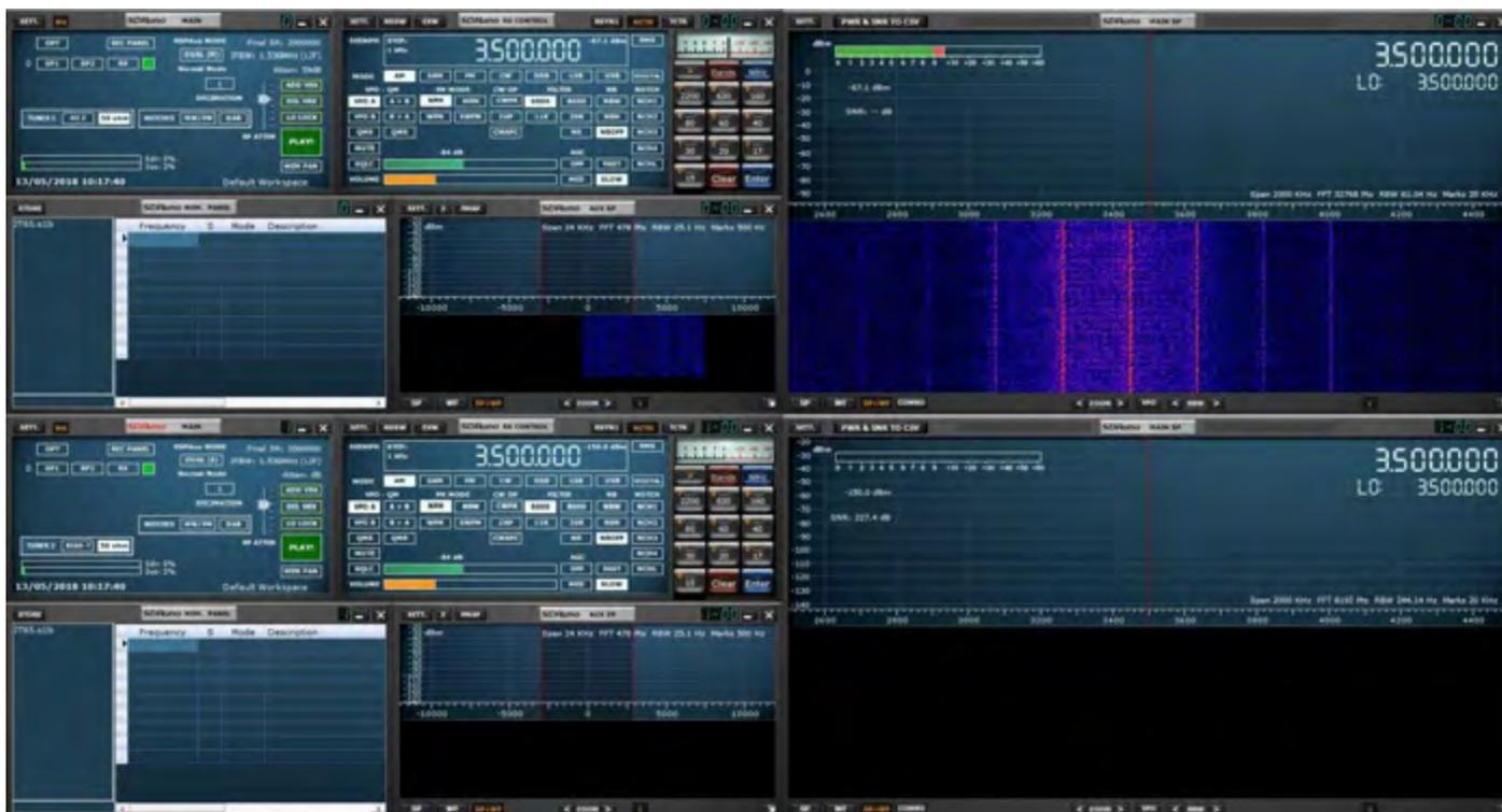
Avant de démarrer le flux pour le tuner esclave, vous devez d'abord le démarrer pour le tuner principal. Si vous essayez de démarrer le tuner esclave avant le premier tuner principal, vous recevrez le message d'erreur suivant:
