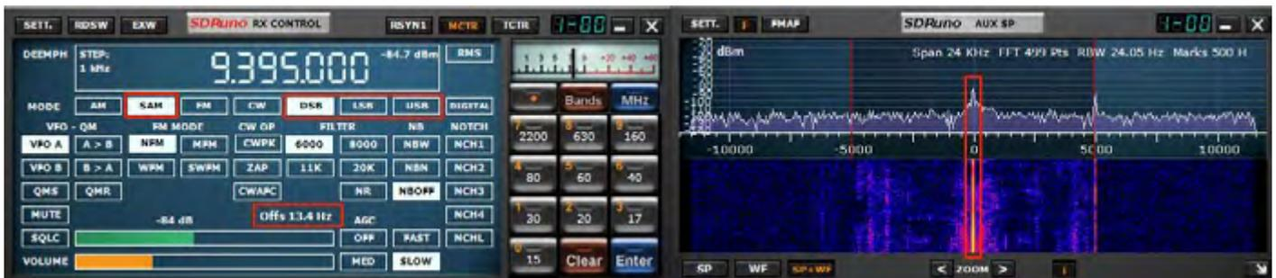
SDRuno implémente un mode SAM hautes performances. Lorsque vous sélectionnez SAM, le dernier sous-mode utilisé est également rappelé (LSB, USB ou DSB). Une fois que SAM est engagé, vous pouvez passer au sous-mode souhaité en cliquant sur les boutons correspondants:
