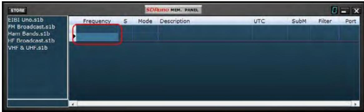
Les nouvelles lignes sont toujours insérées après celle en cours. Pour insérer manuellement une nouvelle ligne (vierge), appuyez sur la touche Ins.
