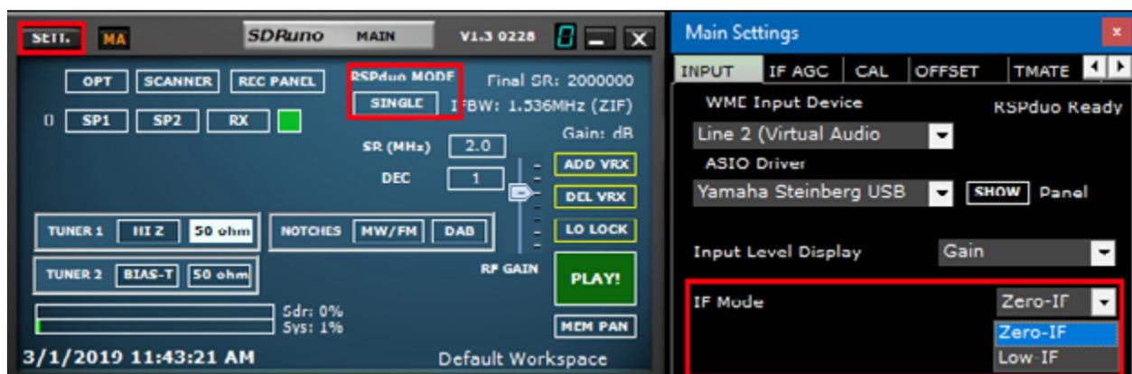
Le panneau principal doit maintenant indiquer que le périphérique fonctionne en mode ZIF (Zero FI) et que la quantité de spectre visualisable peut être modifiée en sélectionnant une fréquence d'échantillonnage différente :
