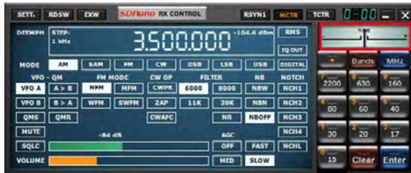
Lorsqu'il est utilisé avec un RSP, le S-Meter est étalonné avec précision. Pour changer la fonction S-mètre en indicateur de syntonisation FM et vice-versa, cliquez simplement dessus. Par défaut, les paramètres de la région IARU 1 sont utilisés. Dans ce mode, S9 = -73 dBm pour les fréquences inférieures à 30 MHz et S9 = -93 dBm pour les fréquences supérieures à 30 MHz. Ce paramètre peut être modifié dans le menu Paramètres du panneau de commande RX.
