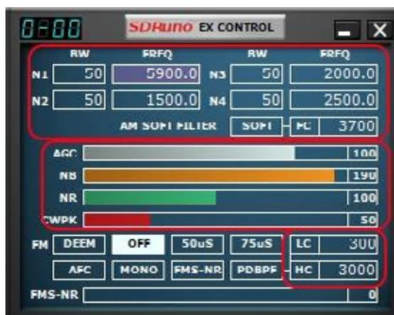
Ces commandes sont facilement reconnaissables car leur arrière-plan devient violet lorsque vous placez le curseur au-dessus d'elles; les filtres coupe-bande BW et Freq en sont quelques exemples. Commandes dans le panneau «RX EX Control»
