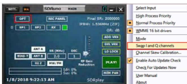
Certains convertisseurs sont conçus pour que sa fréquence LO soit supérieure à la fréquence du signal d'entrée : à cause de cela, le spectre de sortie est inversé. Dans ce cas, le mode spectre inversé doit être activé en cliquant sur le bouton INV. De plus, les canaux I et Q doivent être permutés (Main panel -> OPT-> Swap I and Q Channels (permuter les canaux I et Q)).
