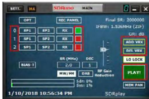
**ADD VRX** - Ceci vous permet d'ajouter un VRX supplémentaire, cela ne peut être ajouté que si le RSP est arrêté. Le VRX supplémentaire doit être dans la bande passante sélectionnée (SR MHz).
