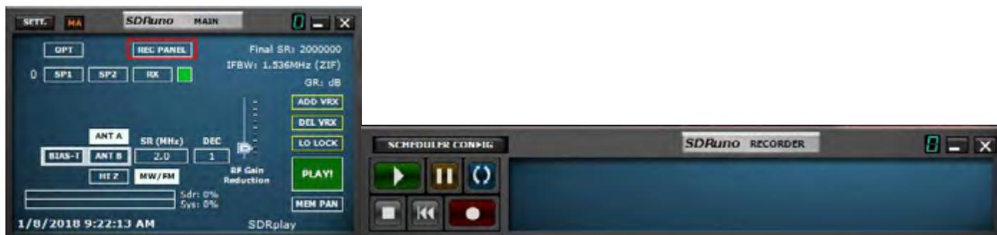
Le panneau Recorder peut être affiché en cliquant sur le bouton “REC” à l’intérieur du MAIN panel.
