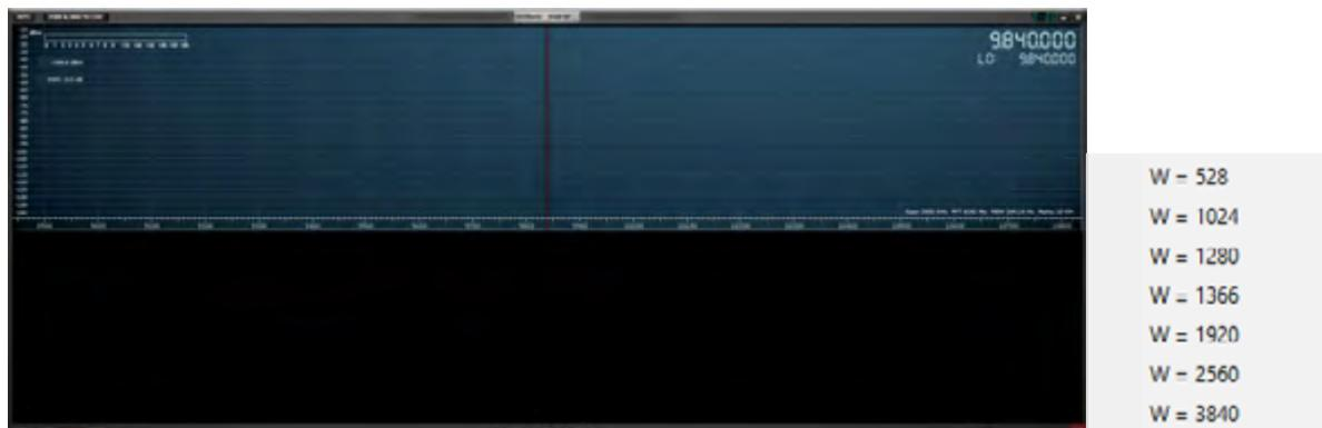
Le Main SP peut être librement redimensionné ou une largeur de résolution prédéfinie peut être sélectionnée en cliquant avec le bouton droit de la souris sur la flèche située dans le coin inférieur droit du Main SP.
