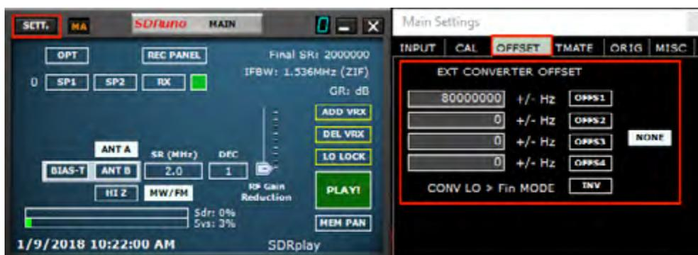
Vous pouvez enregistrer jusqu'à quatre décalages de convertisseur dans chaque instance de SDRuno. Les réglages de décalage sont disponibles dans le Main panel ->Sett.->OFFSET.
