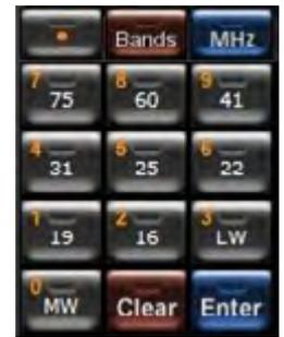
Ham Lower remplit les boutons de bande présélectionnés avec 2200m, 630m, 160m, 80m, 60m, 40m, 30m, 20m, 17m et 15m.
