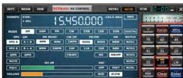
Lorsque vous appuyez sur l'un des boutons de cadrage de la bande Ham ou de la bande de diffusion du RX CONTROL, le bouton de bande sélectionné s'allume en orange, ce qui permet ce qui suit. Verrouillage de la LO, ajustement automatique de la fréquence d'échantillonnage et de la valeur de décimation, ainsi que du mode sélectionné pour la bande sélectionnée. Le panneau MAIN SP «cadre» maintenant la gamme de fréquences complète de la bande choisie.
