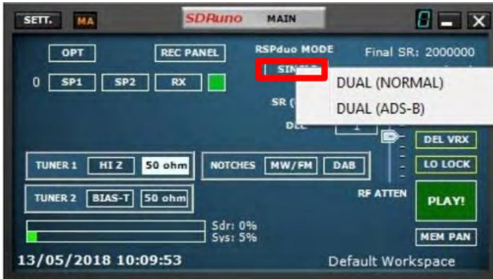
DUAL (NORMAL) - Sélectionnez ce mode sauf si vous avez l'intention d'utiliser ADS-B avec le tuner esclave.
