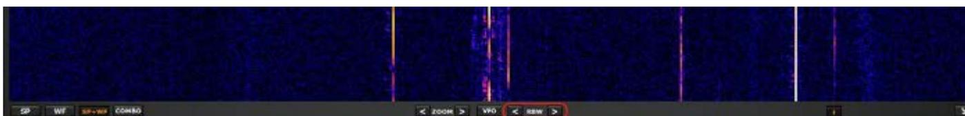
RBW est le détail de l'affichage du spectre. Il détermine la quantité de «résolution» affichée. Une résolution de fréquence très fine peut être obtenue avec des valeurs plus petites. Il n'y a pas de valeur optimale. Cela dépend de la modulation et du nombre de détails que l'utilisateur souhaite observer.
