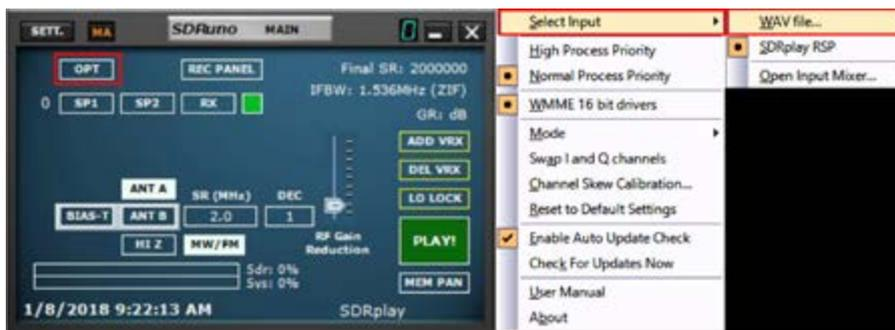
Lancer SDRuno. Avant de cliquer sur PLAY dans la fenêtre MAIN. Cliquez sur le bouton OPT dans la fenêtre PRINCIPALE. Sélectionnez Input et sélectionnez le fichier WAV. La lecture est contrôlée via la fenêtre RECORDER.
