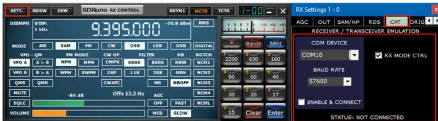
Le contrôle CAT existe depuis au moins 25 ans, il s'agit donc d'une technologie bien connue: il n'est pas nécessaire d'en revoir les bases, mais un petit rafraîchissement peut être utile pour comprendre comment le CAT a été implémenté dans SDRUno.
