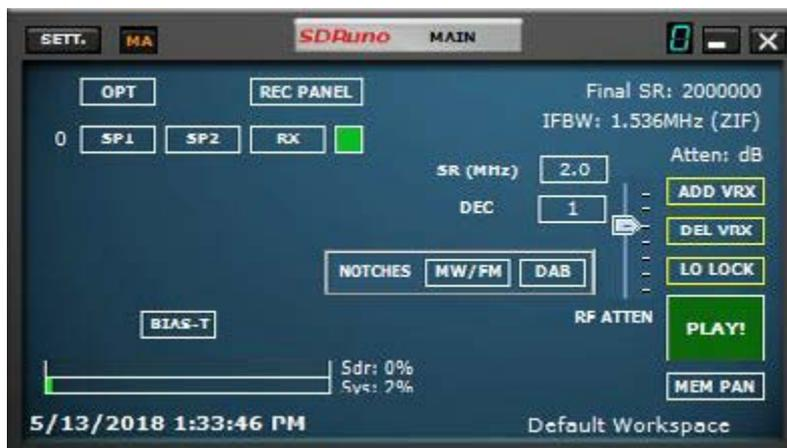
**SETT**- Affiche la fenêtre des paramètres de principaux (MAIN) : INPUT, CAL, OFFSET, TMATE, ORIG, MISC
