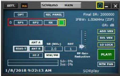
SDRuno peut créer et exécuter plusieurs VRX dans la même instance d'application. Lorsque vous exécutez une instance de SDRplay, un seul VRX est toujours créé : il s'agit du VRX # 0 V. Le VRX # 0 a quelques particularités :
