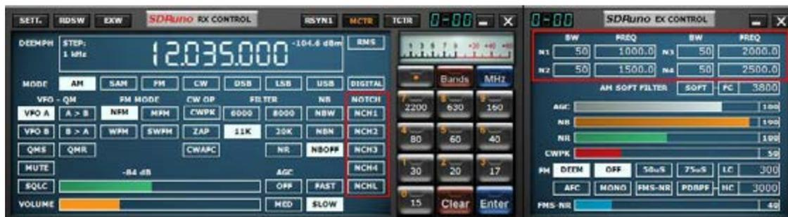
Chaque VRX propose quatre filtres coupe-bande pour supprimer les signaux indésirables, placés avant l'AGC. Chaque filtre Notch peut être activé/désactivé par le bouton correspondant dans la fenêtre RX Control. Les filtres coupe-bande BW et les réglages de fréquence sont disponibles dans la fenêtre RX EX CONTROL. Pour les filtres coupe-bande 1 et 2, les fréquences peuvent être réglées rapidement «à la volée» comme suit :
