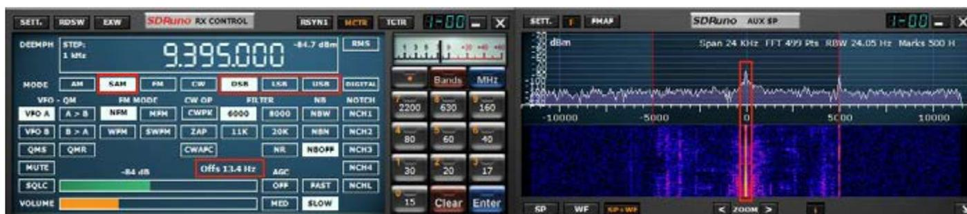
SDRuno implémente un mode SAM haute performance. Lorsque vous sélectionnez SAM, le dernier sous-mode utilisé est également rappelé (LSB, USB ou DSB). Une fois SAM activé, vous pouvez passer au sous-mode souhaité en cliquant sur les boutons correspondants:
