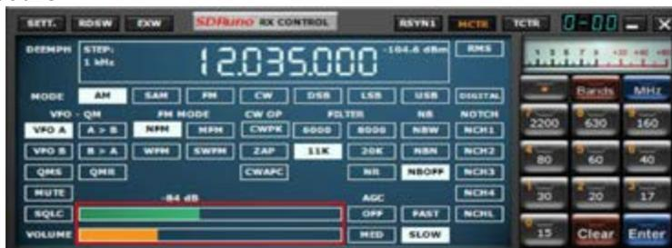
Les curseurs sont utilisés pour certains paramètres tels que le niveau audio, le niveau de squelch, etc.
