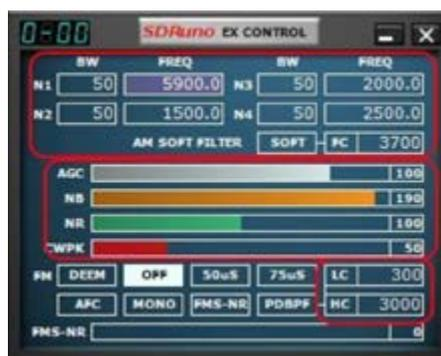
Ces contrôles sont facilement reconnaissables lorsque leur arrière-plan passe au violet lorsque vous placez la flèche de la souris au-dessus d'eux, quelques exemples sont les filtres coupe-bande *BW* et *Freq. controls* dans la fenêtre «RX EX Control»
