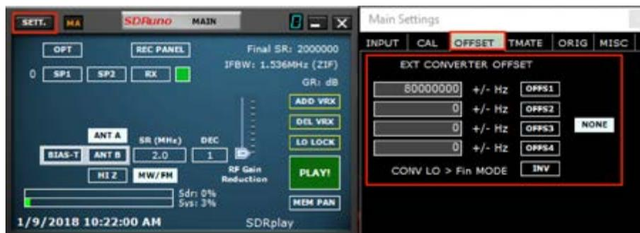
Jusqu'à quatre décalages de convertisseur peuvent être stockés dans chaque instance de SDRplay. Les paramètres de décalage sont disponibles dans la fenêtre MAIN → Sett. → OFFSET.
