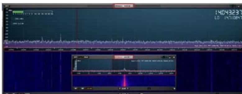
Dans la fenêtre SP1 et SP2, pour le mode d'affichage SP + WF, vous pouvez modifier la proportion du SP par rapport à WF en cliquant avec le bouton droit sur l'échelle de fréquence et en le faisant glisser verticalement jusqu'à la position souhaitée.
