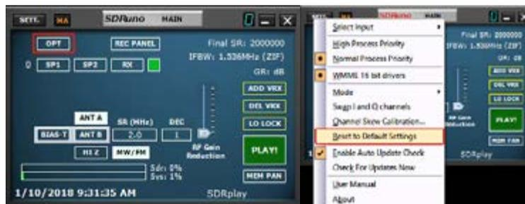
SDRuno peut être réinitialisé à l'état initial par défaut. De la fenêtre MAIN (Principale), cliquez sur le bouton OPT et sélectionnez "Reset to Default Settings" (Réinitialiser les paramètres par défaut) dans le menu déroulant. La réinitialisation de SDRuno ne peut pas être annulée. Tous les paramètres seront effacés et toutes les instances de SDRuno seront fermées.
