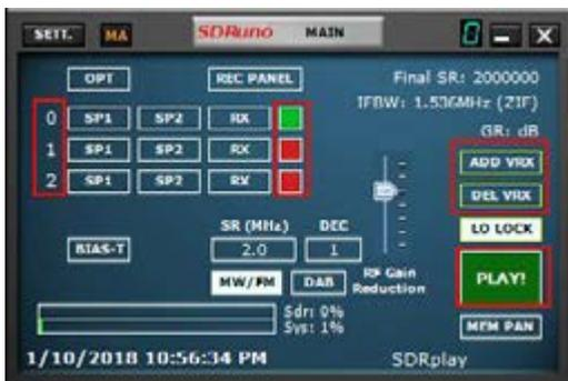
SDRuno doit être arrêté pour ajouter ou supprimer un VRX.
