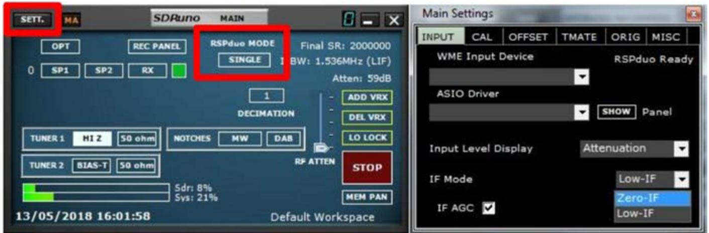
Le panneau principal doit maintenant montrer que l'appareil fonctionne en mode ZIF (Zero IF) et que la quantité de spectre visible peut être modifiée en sélectionnant une fréquence d'échantillonnage différente :
