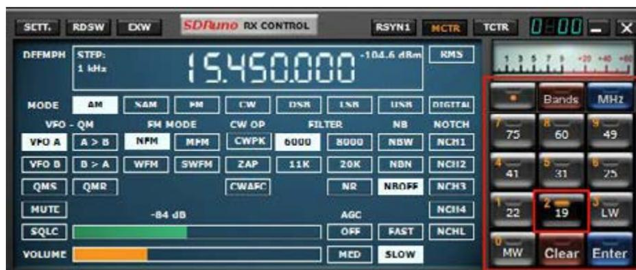
Lorsque vous appuyez sur l'un des boutons de cadrage de la bande de Ham ou de la bande de diffusion dans le RX CONTROL, le bouton de bande sélectionné s'allume en orange, ce qui permet d'effectuer les opérations suivantes. Verrouillage du LO, réglage automatique de la fréquence d'échantillonnage et de la valeur décimale avec le mode approprié sélectionné pour la bande sélectionnée. La fenêtre MAIN SP va maintenant «cadrer» la plage de fréquences complète de la bande choisie.
