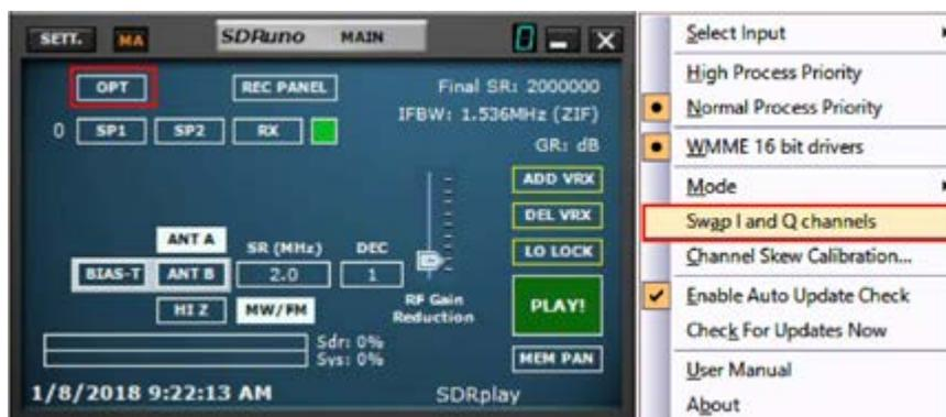
Certains convertisseurs sont conçus pour que sa fréquence LO soit supérieure à la fréquence du signal d'entrée, à cause de cela, le spectre de sortie est inversé. Dans ce cas, le mode spectre inversé doit être activé, en cliquant sur le bouton INV. De plus, les canaux I et Q doivent être permutés (Fenêtre MAIN → OPT → Permuter les canaux I et Q).
