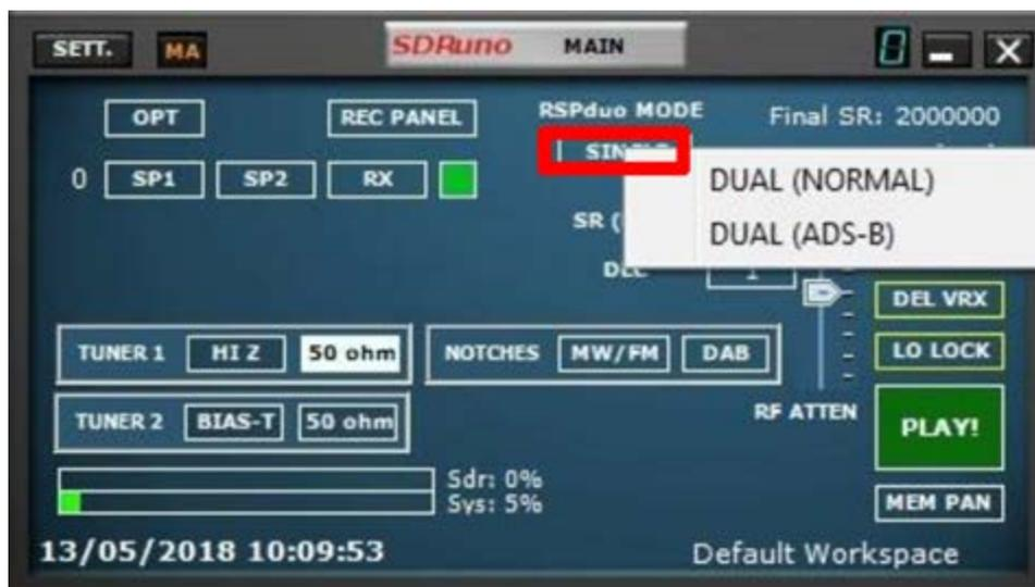
DUAL (NORMAL) - Sélectionnez ce mode sauf si vous avez l'intention d'exécuter ADS-B à l'aide du tuner esclave
