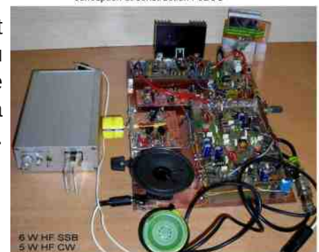
Photo 0 Transceiver BINGO-DUO SSB/CW 40 m Sur une idée de PY2OHH, maquette conception et construction F6BCU 17 août 08
