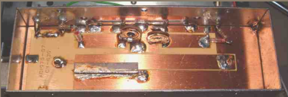
Figure 6: vue ouverte du coupleur directionnel.
