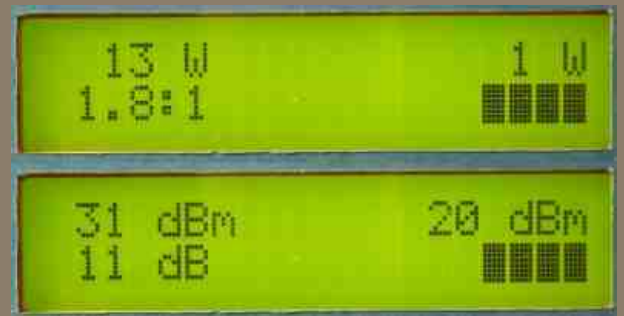
Fig. 4: Affichage en W ou en dBm (pas de la même puissance !).
