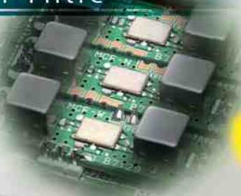
Equippé de 3 « roofing filters » : 3 kHz, 6 kHz et 15 kHz !
