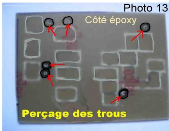
L'oscillateur VACKAR est assemblé sur une plaquette en époxy cuivré simple face de 6 x 7.5 cm (photo 12). Sous la plaque des trous sont percés pour le passage des fils d'alimentation (Photo13.)
