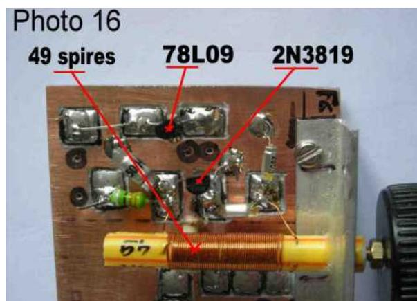
Nous suivons au fur et à mesure de la visualisation des photos 16 et 18 le positionnement des composants à implanter.
