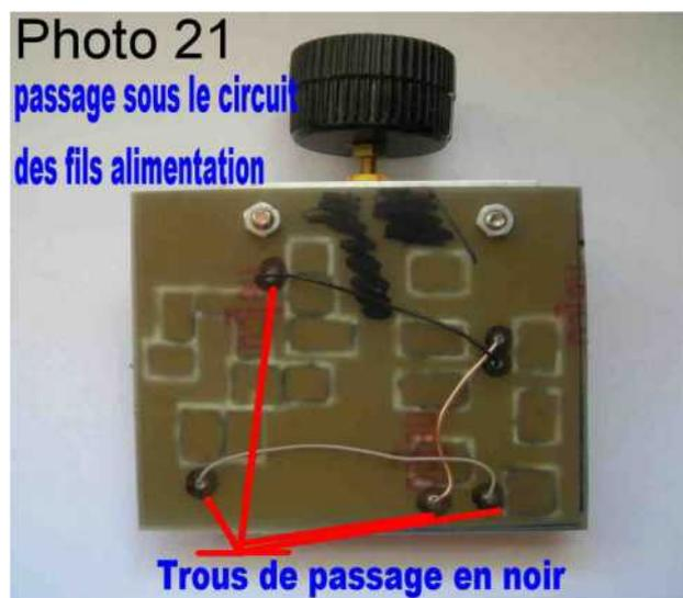
Les fils reliant les points alimentés en + 9 ou 13.8Volts passent dans des trous pré percés sous le circuit imprimé et sont découplés par des capacités au niveau de chaque trou. Cette technique évite bien des instabilités et des retours HF d'un étage à l'autre.
